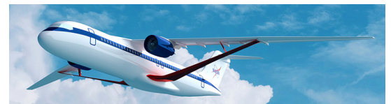
Las alas transónicas reforzadas con armadura pueden ayudar a reducir el consumo de combustible hasta en un 10%. (NASA)
